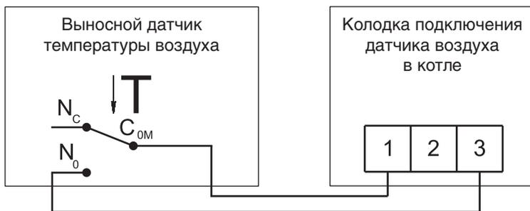
Рис. 5. Схема подключения датчика температуры воздуха
