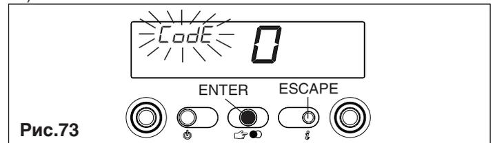
Введите пароль доступа к функциям изменения параметров, поворачивая ручку регулятора температуры ГВС до получения нужного значения. Пароль доступа к программированию параметров, находится внутри панели управления. Подтвердите введенное значение, нажав кнопку ENTER.
