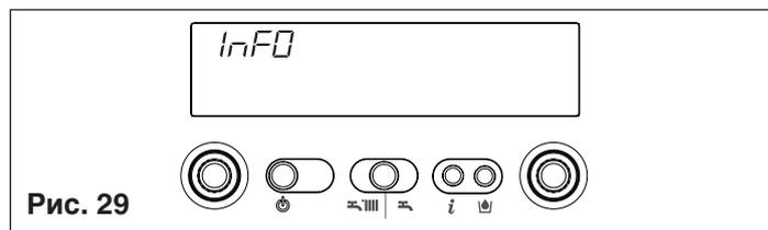
**Info 1** только при подключенном внешнем (уличном) датчике, отображается уличная температура (например, 12°C) (рис. 30). Отображаемые на дисплее значения заключены в пределах от -40°C до +40°C. При выходе за эти пределы на дисплее отобразится "- -"
