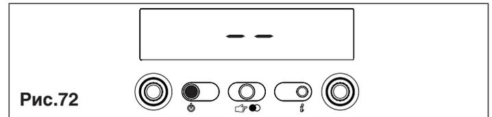
При изменении параметров кнопка «выбор режима» выполняет функцию ENTER (ввод), кнопка
