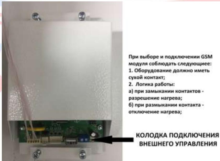
Рисунок 9. Подключение GSM модуля к электродкотлу РЭКО серии ПМ
