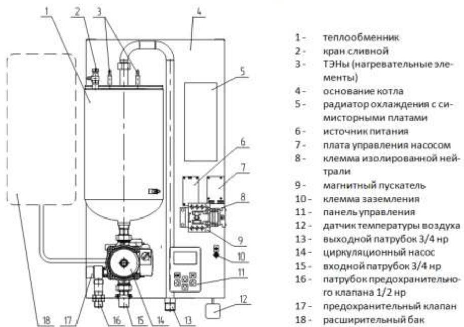
Рисунок 2. Устройство отопителя РЭКО серии ПМ
