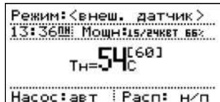
Режим работы «**Внешний датчик**», «**Каскад**» предназначен для управления отопителем посредством внешнего датчика, подключенного к соответствующему разъему на плате управления отопителем. При этом в активной фазе котел будет поддерживать заданную температуру теплоносителя. В пассивной фазе нагрев происходит не будет.
