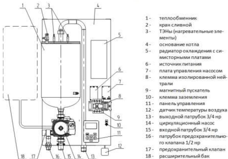
Рисунок 2. Устройство отопителя РЭКО серии ПМ
