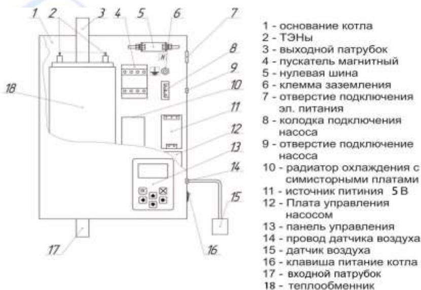
Рисунок 1. Устройство отопителя РЭКО серии П
