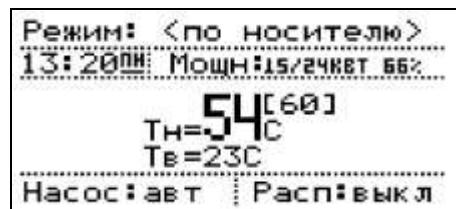
Экран основных данных предназначен для отображения основной информации о работе отопителя:
