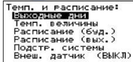
Функциональное подменю «Температура и расписание» предназначено для доступа к экранам:
