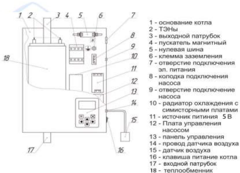
Рисунок 1. Устройство отопителя РЭКО серии П
