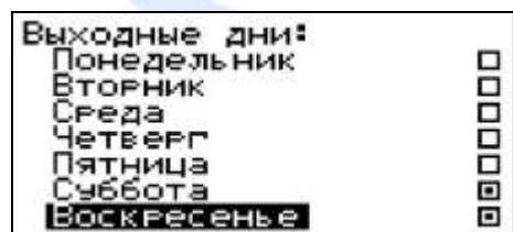
Экран «Выходные дни» предназначен для установки соответствия дня недели выходному дню.
