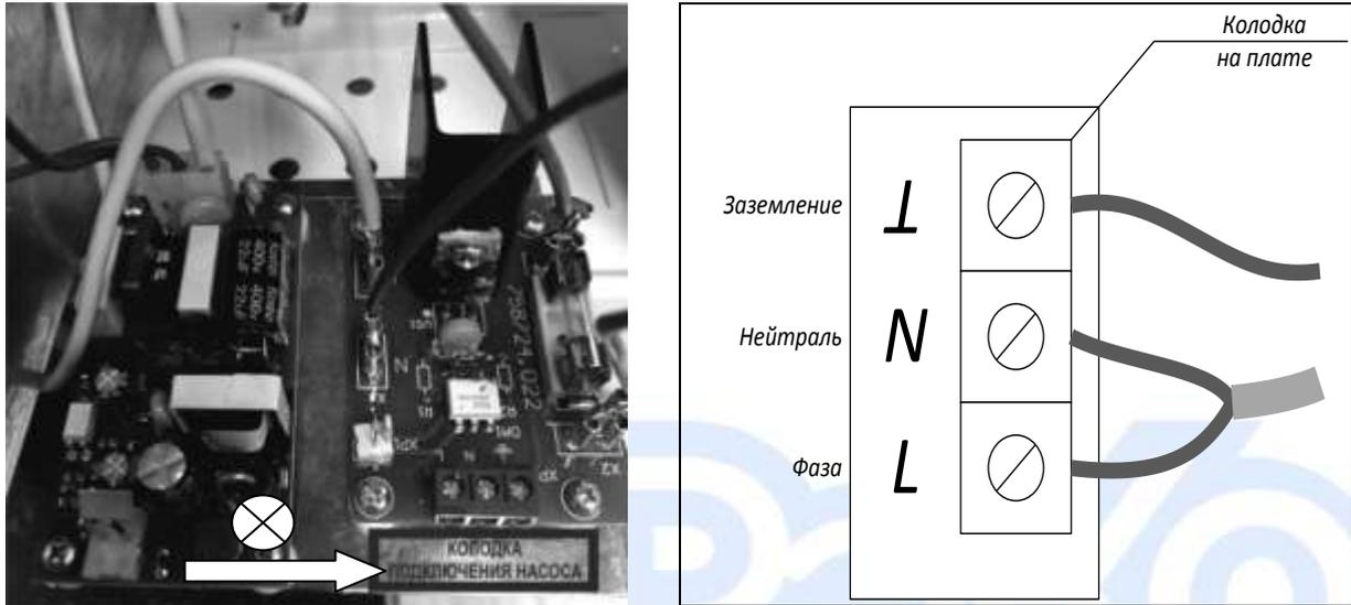
Рисунок 8. Подключение GSM модуля к электродотлу РЭКО серии П
