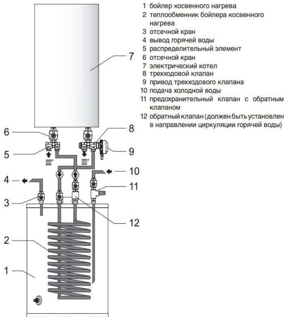
Рисунок 15. Типовая схема подключения бойлера косвенного нагрева
