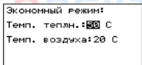
Экраны «Экономный режим» и «Стандартный режим» предназначены для установки целевых величин температуры теплоносителя и воздуха для каждого из режимов.
