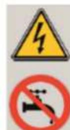
Данную процедуру следует проводить только после отключения котла от источника питания и от системы отопления
