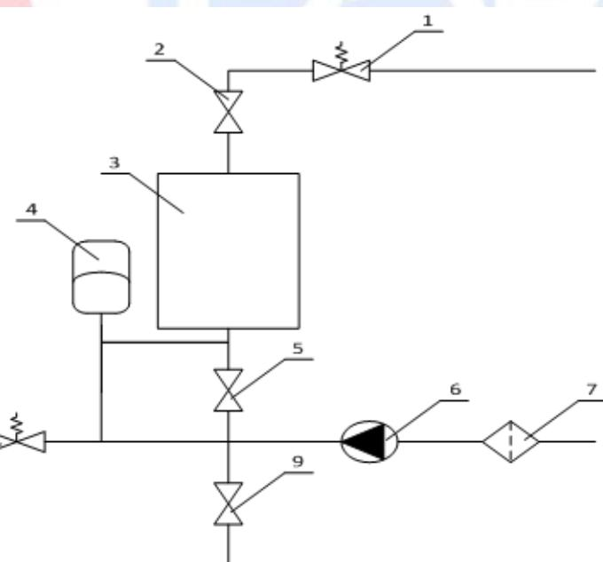
Рисунок 3. Рекомендуемая схема подключения отопителя в отопительную систему
