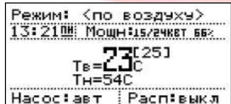
Режим работы «**По воздуху**» предназначен для поддержания заданной температуры воздуха. Температура теплоносителя выбирается автоматически. Данный режим поддерживает работу по расписанию.
