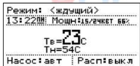
Режим работы «**Ждущий**» предназначен для перевода отопителя в режим ожидания, при этом нагрев теплоносителя будет осуществляться только в случае переохлаждения теплоносителя (не ниже +5С) для предотвращения возможности его замерзания.
