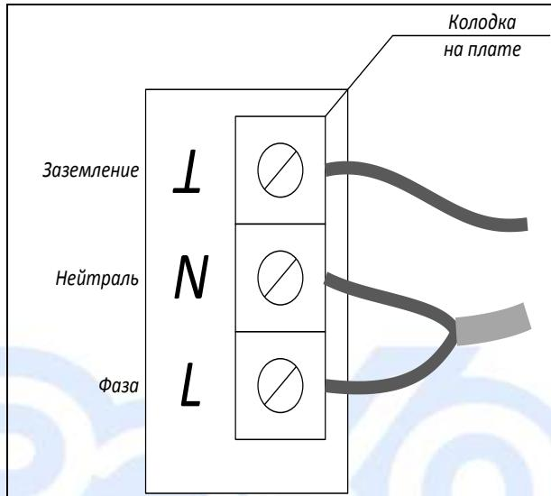
Рисунок 8. Подключение GSM модуля к электрокотлу РЭКО серии П
