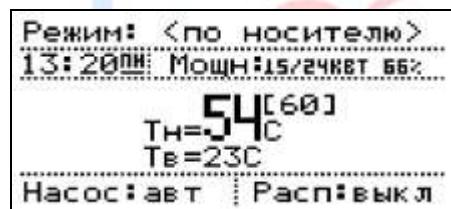
Режим работы «**По носителю**» предназначен для поддержания заданной температуры теплоносителя в системе. При этом температура воздуха не учитывается. Данный режим поддерживает работу по расписанию.
