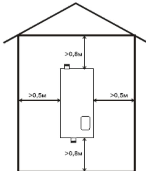
Схема установки электрического котла
